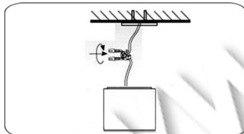
Provući napojni kabl i pravilno ga povezati pomoću kleme sa lampom.
