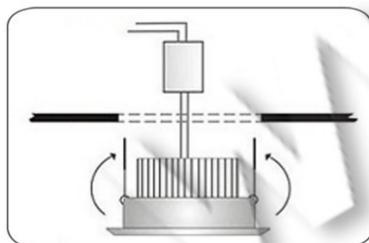
Povezati napojne kablove sa transformatorom pomoću kleme. Pomoću metalnih opruga smestiti lampu u plafon.
