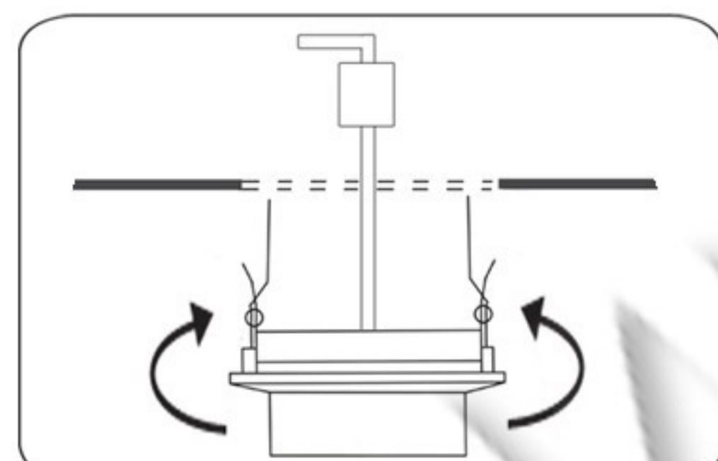
Povezati napojne kablove sa transformatorom pomoću kleme, a zatim povezati sijalično grlo sa transformatorom.
