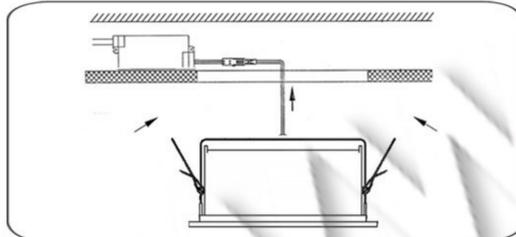
Povezati napojne kablove sa transformatorom pomoću kleme, a zatim povezati sijalično grlo sa transformatorom.
