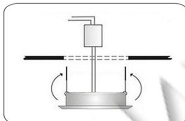
Povezati napojne kablove sa transformatorom pomoću kleme, a zatim povezati sijalično grlo sa transformatorom. Pomoću metalnih opruga smestiti lampu u plafon.
