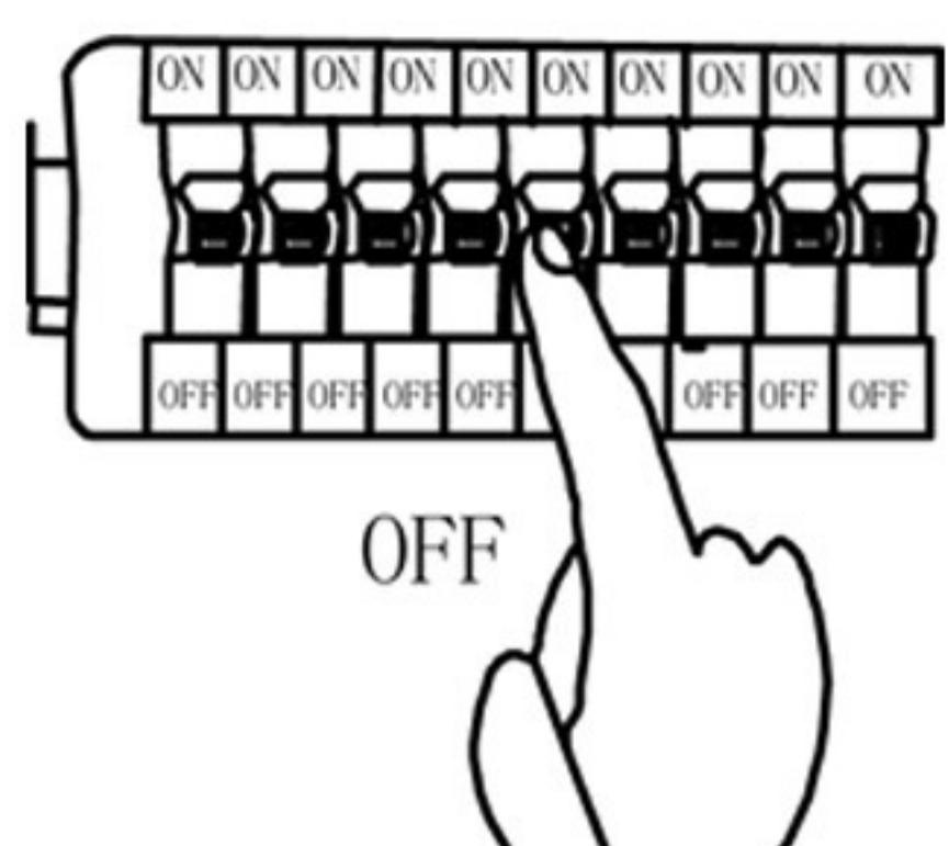
Isključiti mrežni napon na već montiranoj šini.
