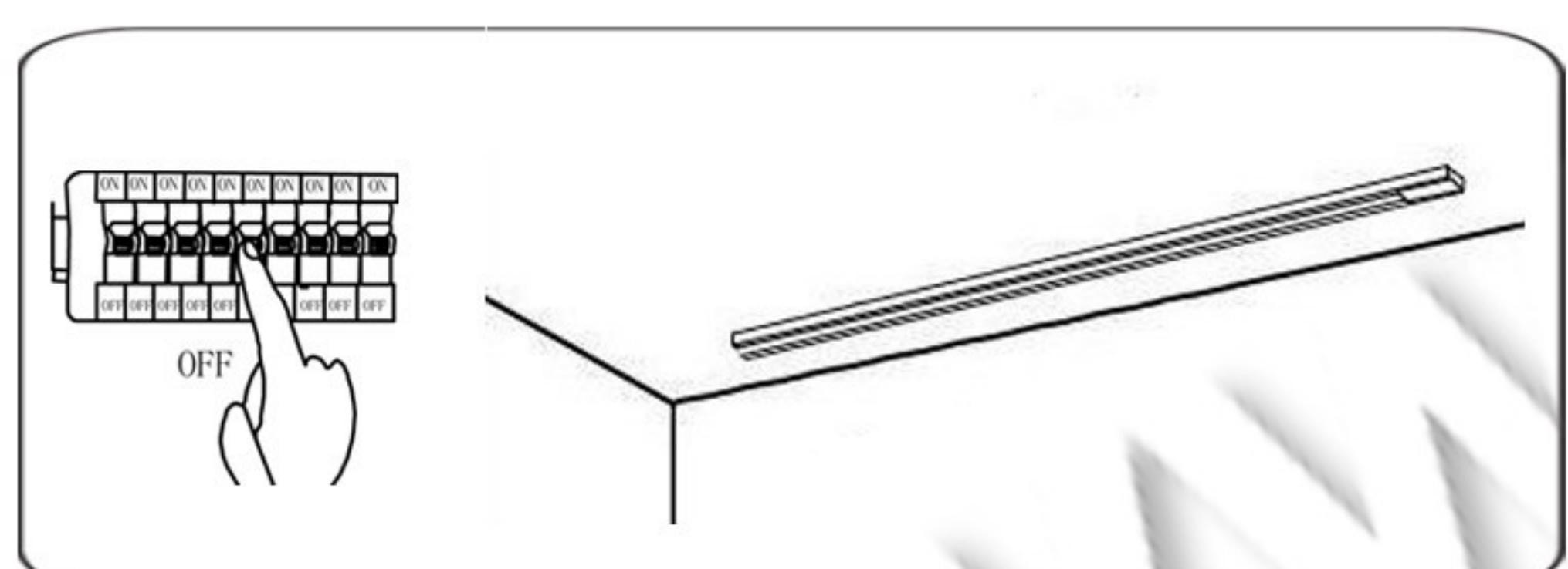
Isključiti mrežni napon na već montiranoj šini.
