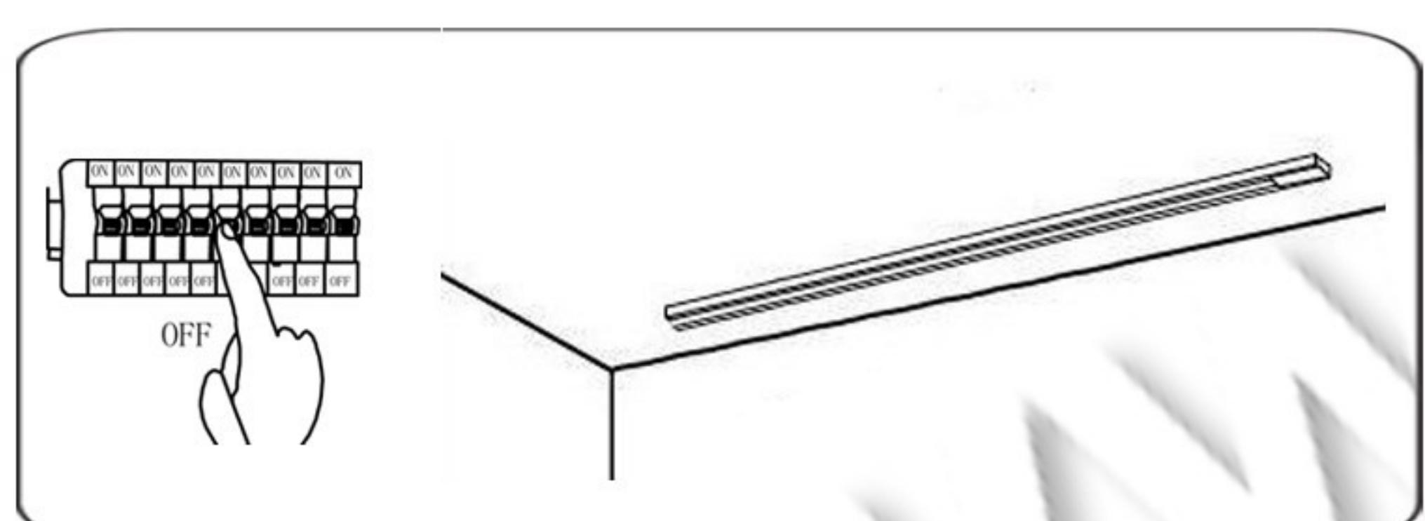
Isključiti mrežni napon na već montiranoj šini.
