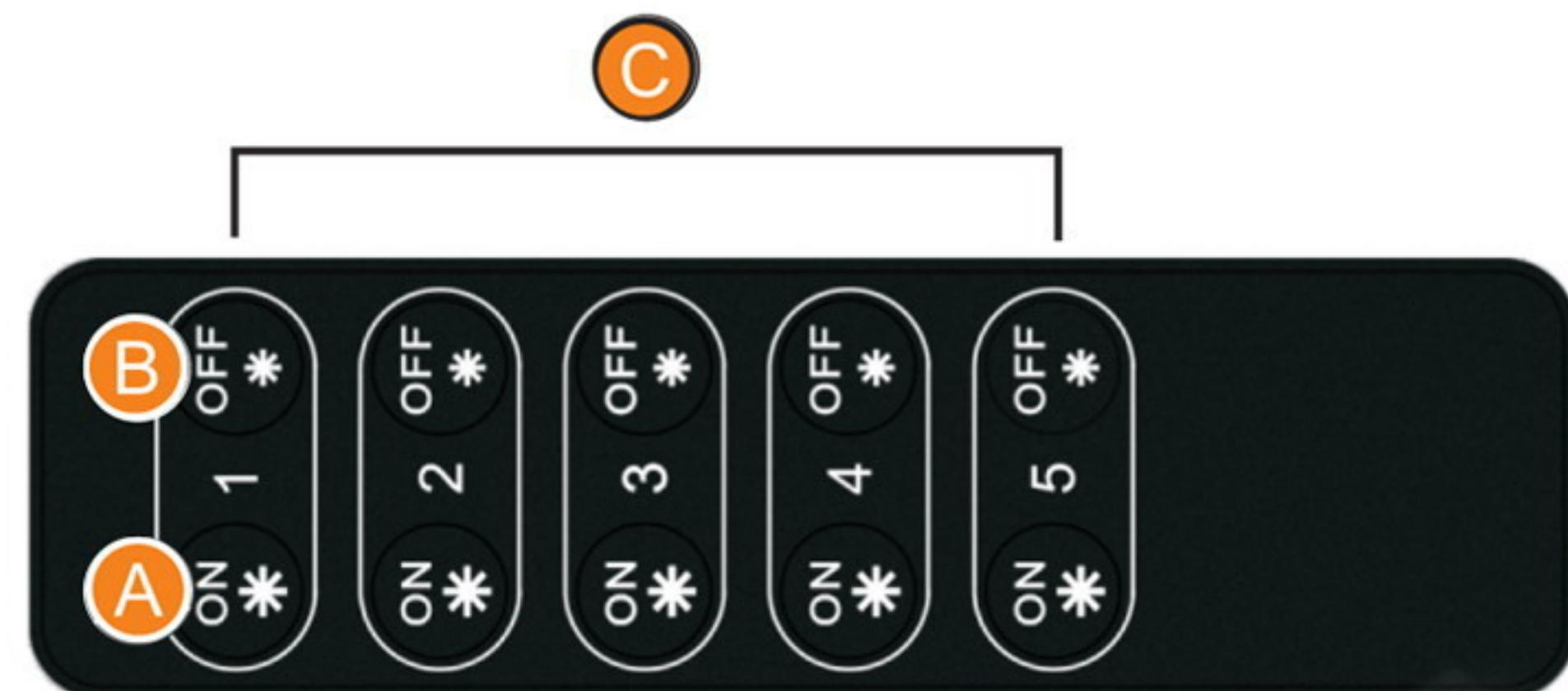
A) Kratak pritisak na dugme za uključivanje (paljenje). Duži pritisak za pojačavanje intenziteta.
